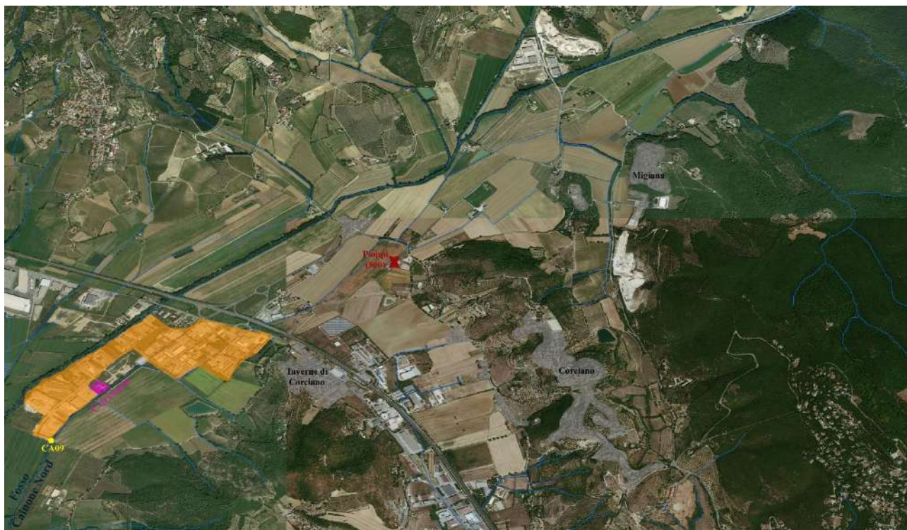
Figura 8.8.1 – Fosso Cainone Nord, identificazione del corso d'acqua e localizzazione dei punti di campionamento. In grigio sono indicate le aree densamente abitate, in arancione le zone industriali, in magenta gli impianti di depurazione. Il simbolo rosso rappresenta gli scarichi rilevati in alveo. La X indica gli allevamenti suinicoli ricadenti nel bacino idrografico del fosso.
