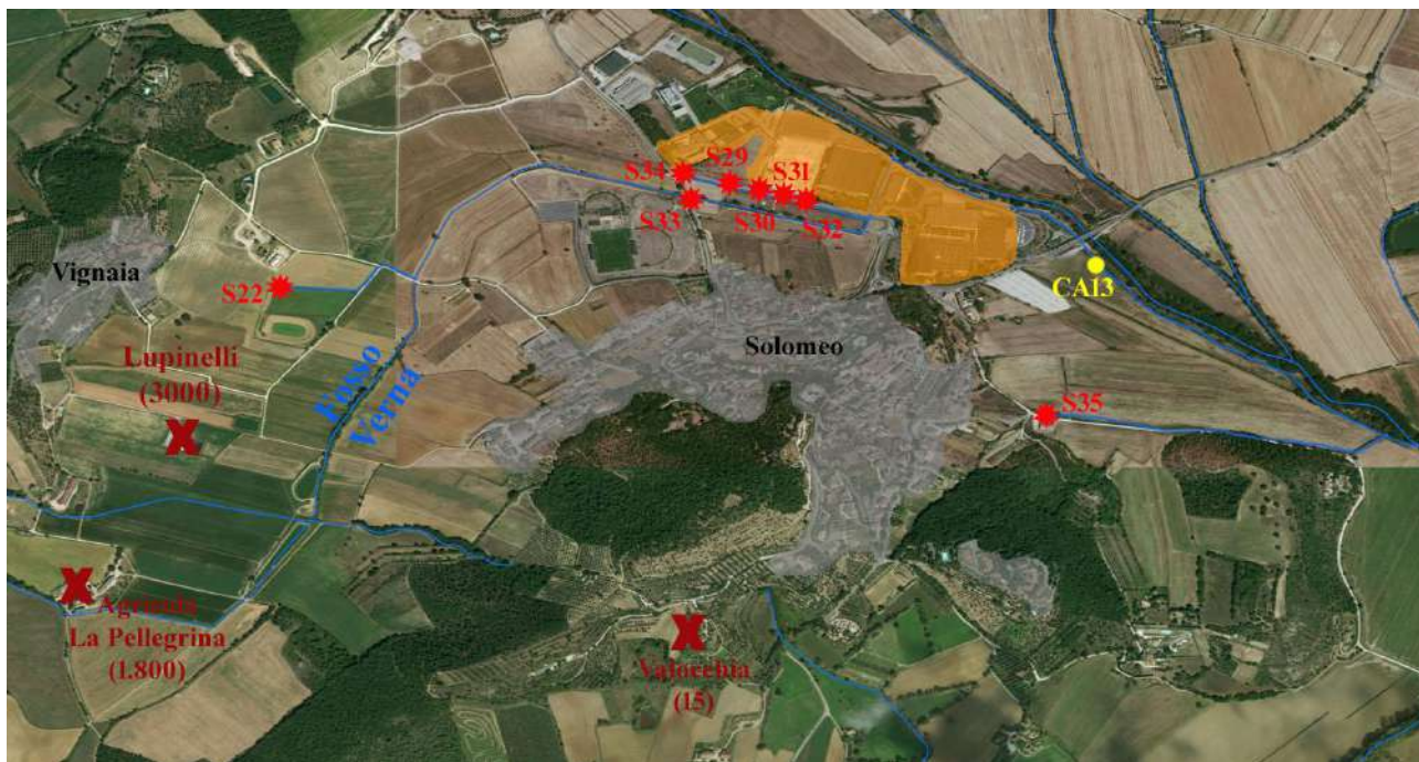
Figura 8.11.1 – Fosso Verna, identificazione del corso d'acqua e localizzazione dei punti di campionamento. In grigio sono indicate le aree densamente abitate, in arancione le zone industriali. Il simbolo rosso rappresenta gli scarichi rilevati in alveo. La X indica gli allevamenti suinicoli inclusi nel bacino idrografico del fosso.
