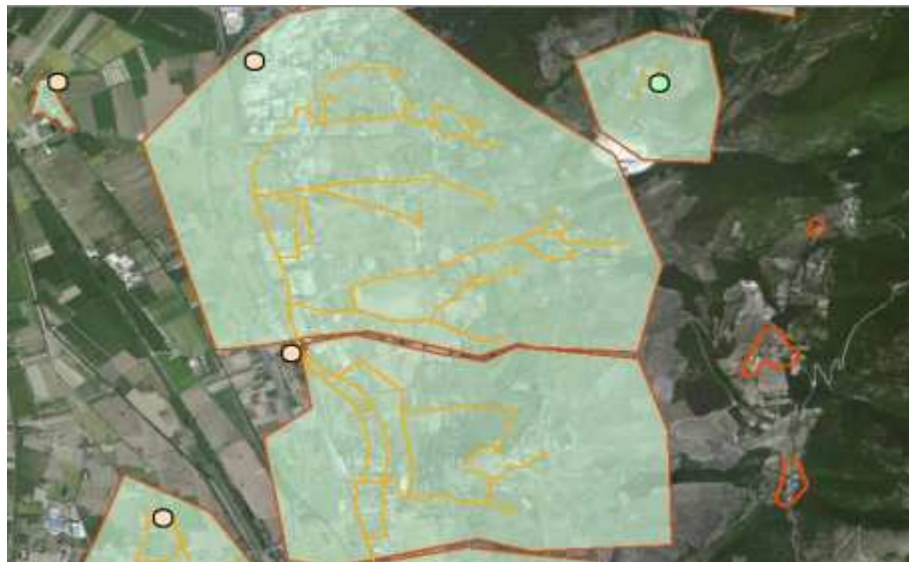
Fig. 16 - Scarsa accuratezza tematica e completezza delle informazioni sui collettori fognari così da rendere difficilmente interpretabile l'estensione dell'area fognata e l'attribuzione univoca all'impianto;
