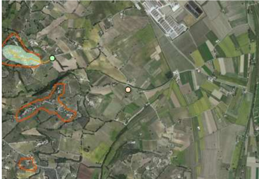
Fig. 13 - Presenza di un depuratore senza un'area fognata a cui collegarlo
