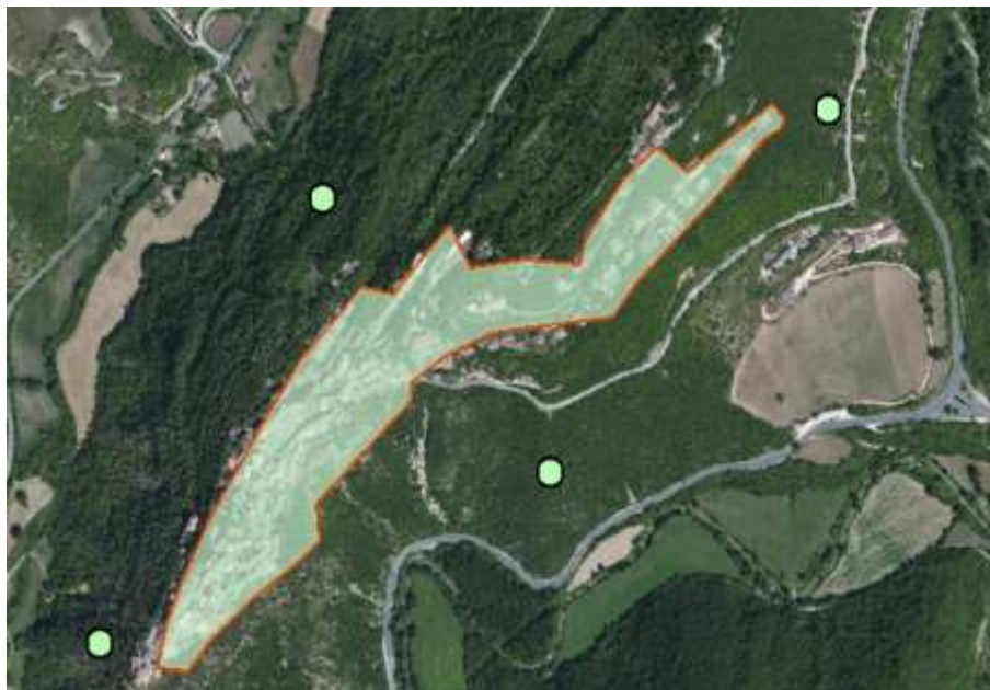
Fig. 14 - Presenza di più impianti in un'unica area fognata non suddivisa;
