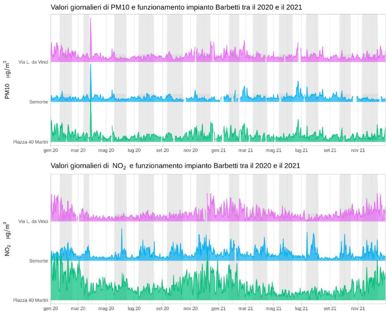
Da questi non è evidente una correlazione tra i valori misurati e i periodi di funzionamento dell'impianto se non per NO<sub>2</sub> presso la stazione di Semonte dove è abbastanza evidente come i valori di NO<sub>2</sub> misurati dipendano abbastanza esclusivamente dal funzionamento dell'impianto.
