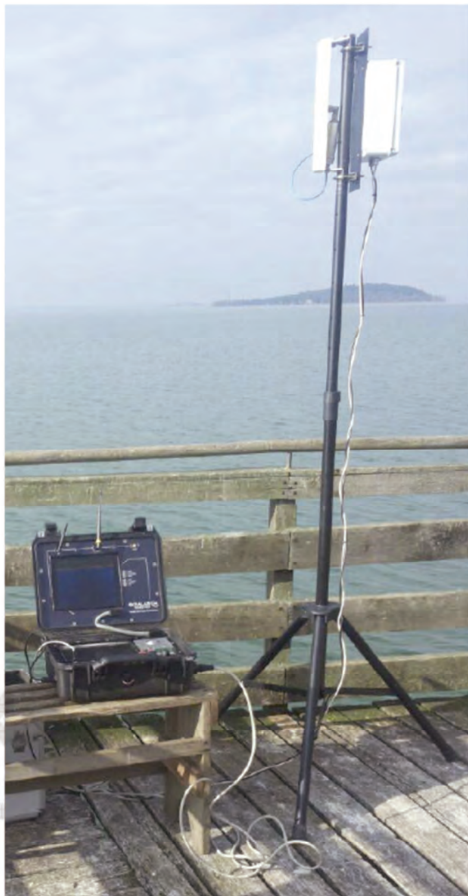
Figura 23: Ground Control Station e antenna per trasmissione dati e telemetria del Galileo
