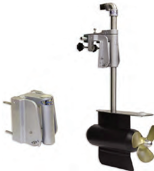
Figura 1: Motore fuoribordo principale per la navigazione del Trasibot .
